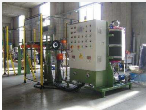
Line for primer for PIR panels
